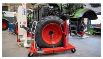
Déposes roues pratique et ergonomique pour enlever des roues larges.
