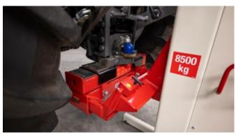
Traverses multifonctions pour levage de véhicule avant et arrière 'roues pendantes' avec à deux colonnes.
