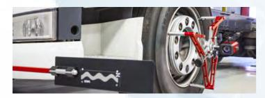
Avec le système cam aligner, le véhicule est simplement avancé d'un demi-tour de roue en roulant. Quel gain de temps ! De plus ceci permet surtout de mesurer des véhicules ailleurs que dans un atelier.
