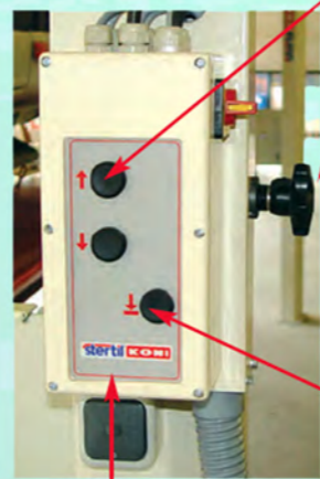
Sécurité totale Commandes «homme-mort» et crémaillères mécaniques
