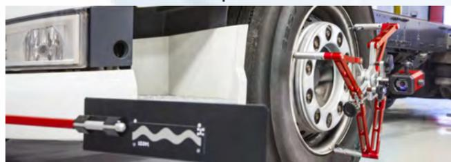
Avec le système **cam aligner**, le véhicule est simplement avancé d'un demi-tour de roue en roulant. Quel gain de temps et plus ceci permet surtout de mesurer des véhicules ailleurs que dans un atelier.
