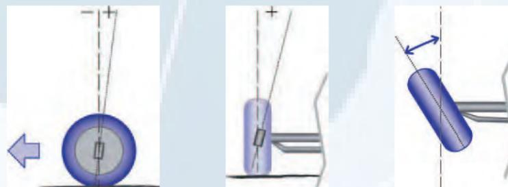
Les gyroscopes dans les caméras et l'inclinomètre permettent de calculer le chasse, l'inclinaison des pivots et autres angles de direction. L'inclinomètre corrige la différence de hauteur et l'horizontalité de l'essieu mesuré.
